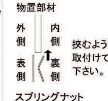
左右後板に各1ヶ所にスプリングナットを取付けて下さい。
