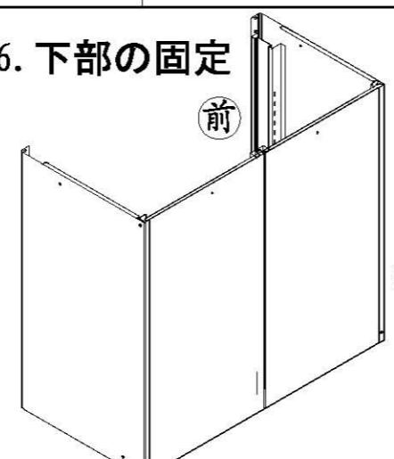
穴が合わない場合は、ドライバーの先を穴に差込むなどして調整してください。
